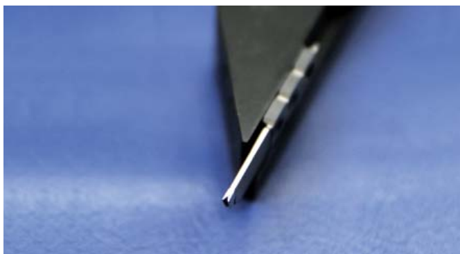
Utensile per il taglio di particolari a pareti fine
