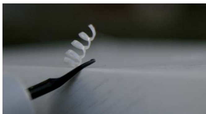
Rimozione bave mediante sbavatore manuale
