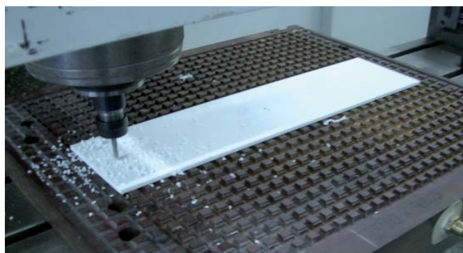
Bloccaggio mediante aspirazione
