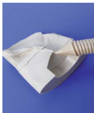
Rottura dovuta ad un grande asporto di materiale
