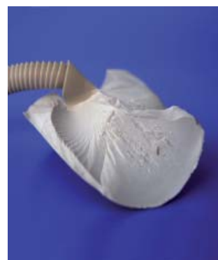
Rottura dovuta ad un grande asporto di materiale
